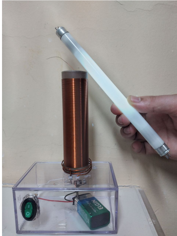
Figura 12 – Mini Bobina de Tesla acendendo a lâmpada.
