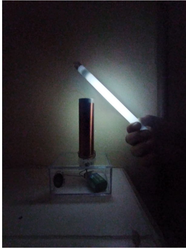
Figura 13 – Mini Bobina de Tesla acendendo a lâmpada.
