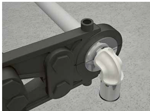
Figura 21 – Utilização do alicate crimpador em tubo PEX.
