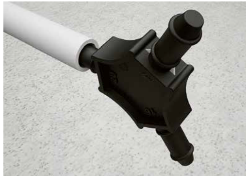
Figura 20 – Inserção do calibrador no tubo PEX.
