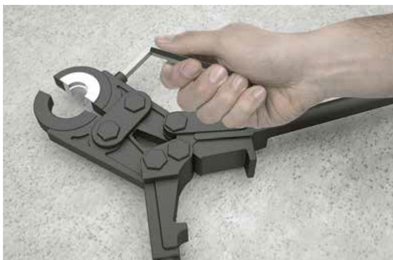
Figura 19 – Colocação do anel de crimpagem com auxílio de chave em L.
