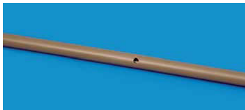
Figura 4 – Trecho danificado de tubulação.
