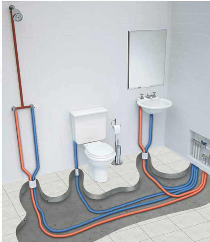
Figura 11 – Instalação hidráulica de água fria e quente com PEX.
