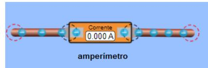
Você deve colocar dois amperímetros, um amperímetro antes das três lâmpadas e outro depois delas.
