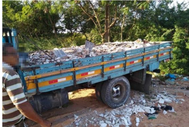
Figura 26 – Caminhão flagrado com RCC para depósito irregular
