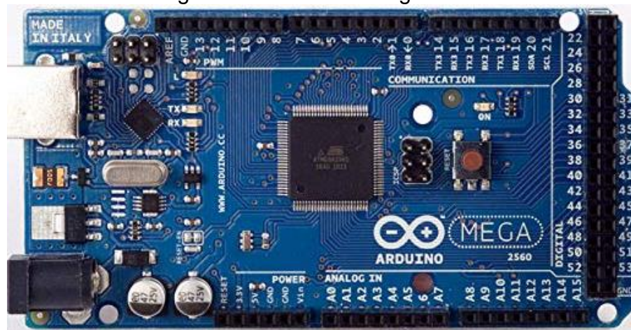
Figura 2 - O Arduino Mega 2560.
