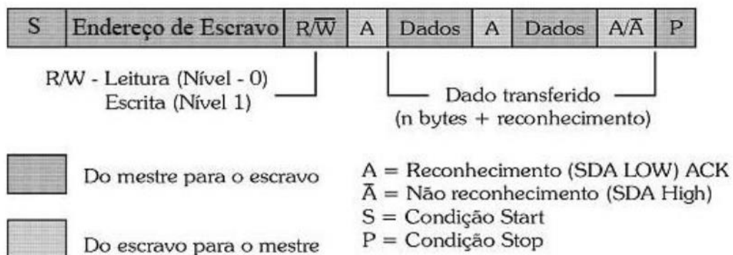
Figura 6 - Funcionalidade mestre-escravo para uma I2C.
