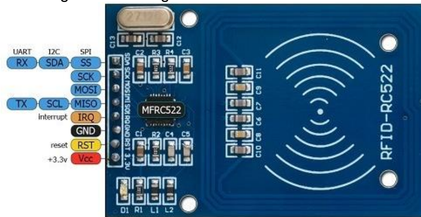
Figura 12 - Pinagem do sensor RFID RC522.
