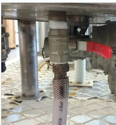
válvula do reator de hidrólise
