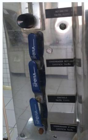
Abra a válvula azul do meio (CONTROLE VÁLV. VINHO) que ficam ao lado esquerdo do painel.
