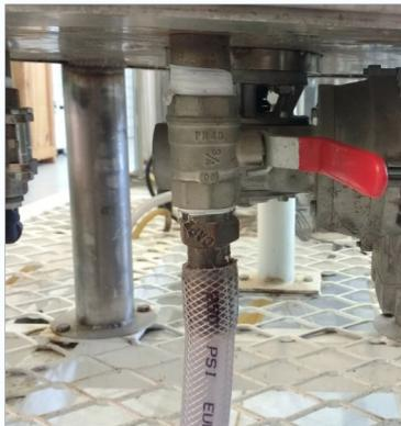
válvula do reator de hidrólise
