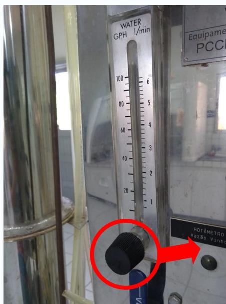
**Atenção:** É necessário manter o controle de vazão do vinho para que a temperatura do topo da coluna estabilize na faixa de 78—82°C.
