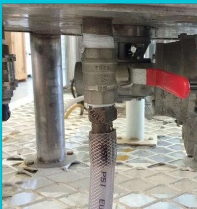
Verifique a posição das válvulas de saída para o ralo para não haver perda do material. Mantenha-as fechadas na posição horizontal.
