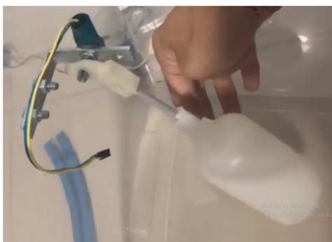
*Imagem 5: Boia com potenciômetro para medição do nível (Fonte: Autoral).*
