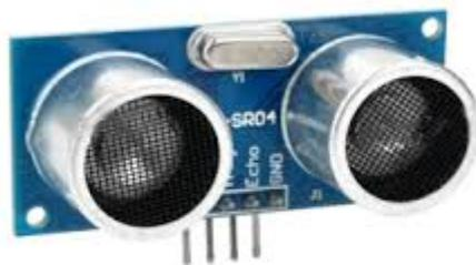
*Imagem 3: Sensor Ultrassônico (Fonte: Site i2celetronica).*
