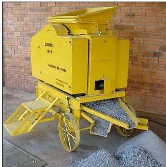
Figura 2 – Triturador de entulho queixada Fonte: Disponível em: < http://www.ctrclassea.com/where-to-buy/ >. Acesso em: 02 mar. 2021.
