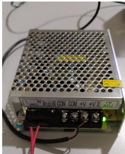
Figura 7. Fonte de tensão 24V-5A.
