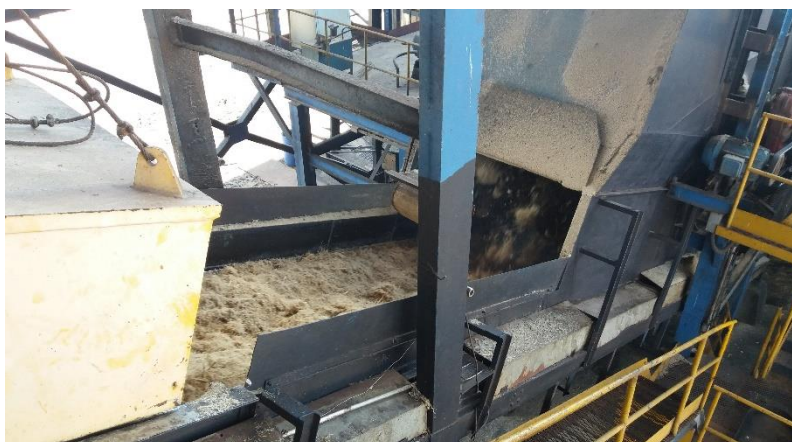
Figura 9. Triturador para desfibrar a cana de açúcar.
