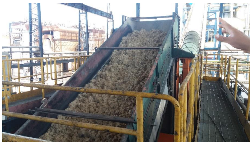
Figura 14 – Bagaço seco que segue para as caldeiras.
