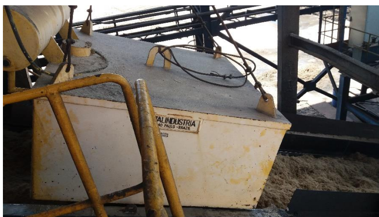
Figura 10. Super imã para retirada das impurezas de ferro.
