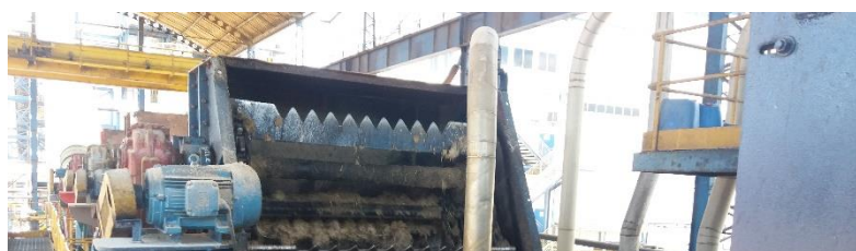
Figura 11. Entrada das moendas para prensagem da cana.
