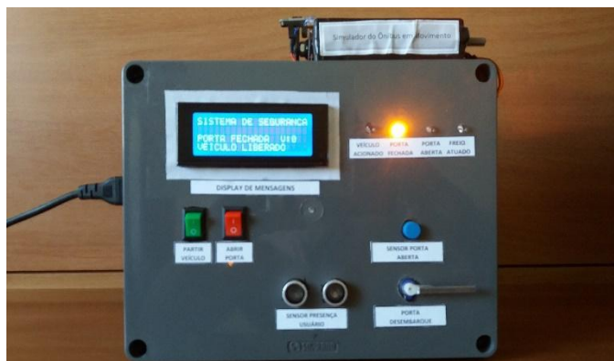
Figura 22- Led indicando porta fechada
