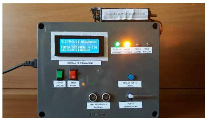
Figura 24 - Led indicando porta fechada e ônibus em movimento
