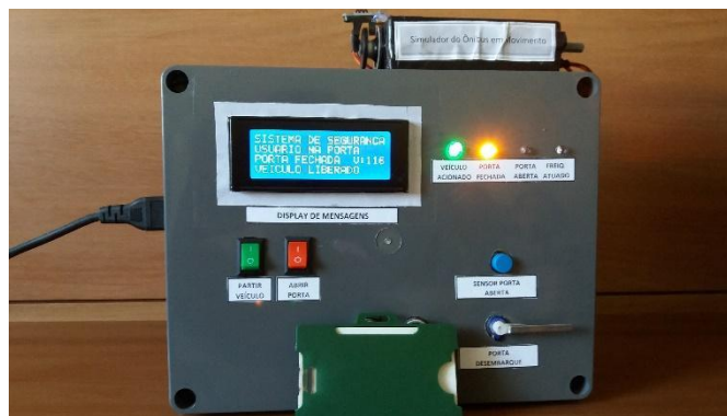
Figura 25- Led indicando porta fechada e ônibus em movimento
