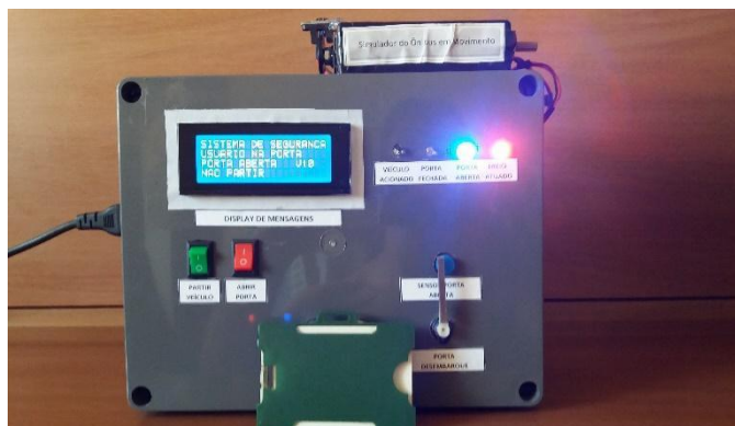
Figura 23- Led indicando porta aberta e freio auxiliar bloqueado
