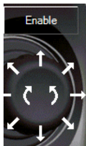
Figura 5.6- Detalhe aumentado do botão Enable no FlexPendant.
