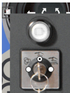
Figura 7.3 - Desligar e re-ligar os motores.
