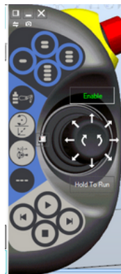
Figura 6.7 - Manipular com o Joystick.
