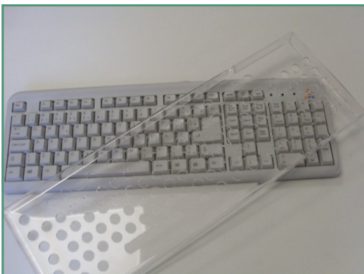
◀ Máscara para teclado. Evita que mais de uma tecla seja acionada ao usar o teclado.
