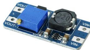
Figura 8 – Módulo boost step up
