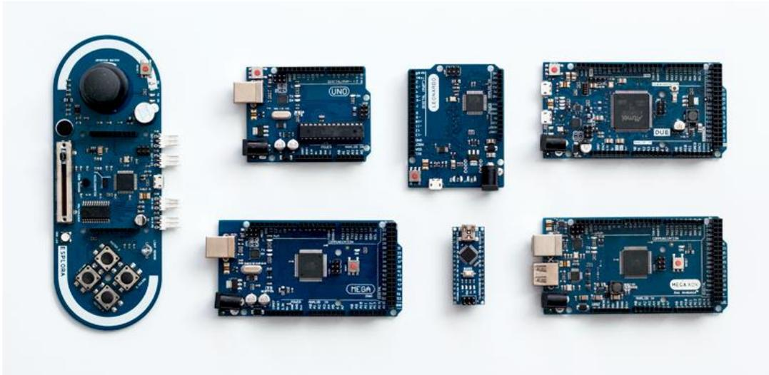
Figura 1 - Modelos de placa arduino
