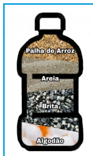
Figura 1. Ilustração da composição do filtro orgânico elaborado.
