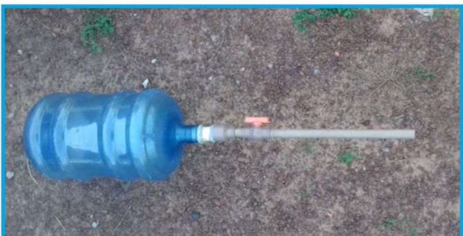
Figura 4 – Equipamento construído para a captação de biogás.
