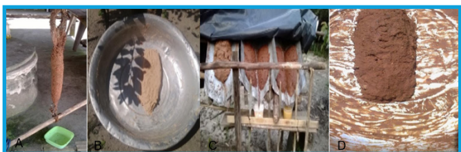
Figura 3. (A) Extração do óleo de andiroba em tipiti. (B) Extração a pleno sol. Escoamento do óleo do “pão” (C) em giral, (D) em bacia de alumínio, respectivamente.
