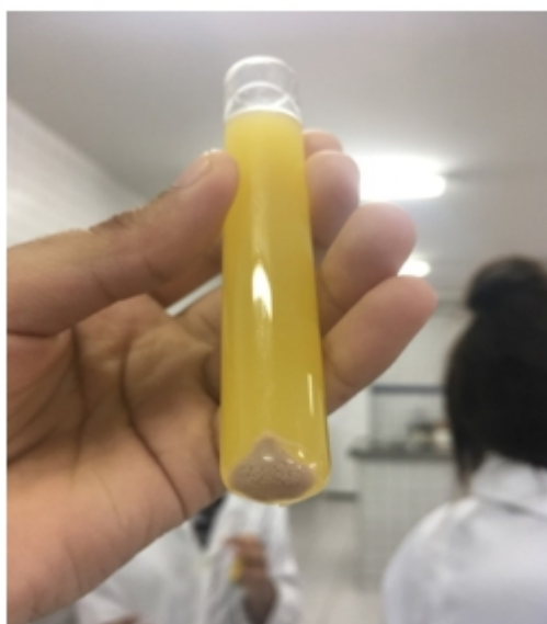
Figura 6 - Remoção dos Fosfatídeos Presente no Óleo de Oiticica. Fonte: Autoria Própria.
