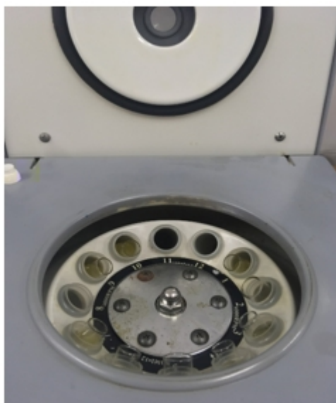
Figura 5 - Óleo de Oiticica sendo Centrifugada no Processo de Degomagem. Fonte: Autoria Própria.
