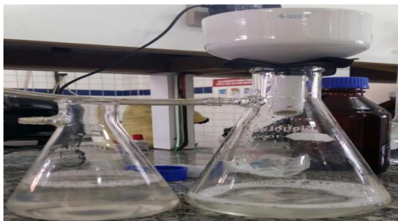
Figura 13: Água tratada sendo filtrada
