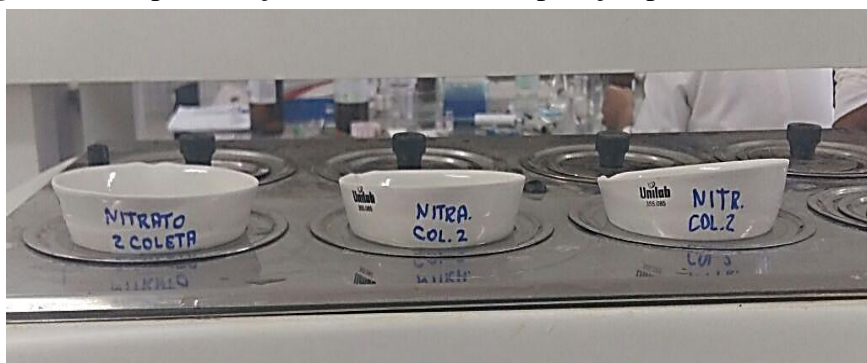
Figura 16: Representação do método de evaporação para análise de sólidos
