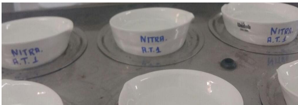
Figura 23: Procedimento de evaporação da amostra para a análise de nitrato
