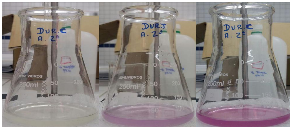
Figura 18: amostra antes da adição do indicador (a), após a adição do indicador (b) e após a titulação (c)
