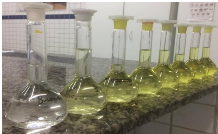
Figura 21: Soluções para a determinação da curva de calibração
