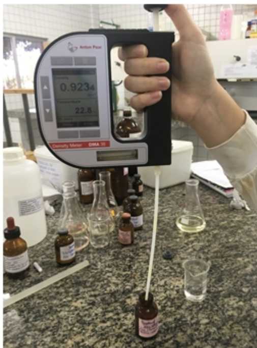
Figura 6 - Obtenção do valor da densidade do biodiesel de oiticica a partir do uso do densímetro Anton Paar DMA 3. Fonte: Autoria Própria.
