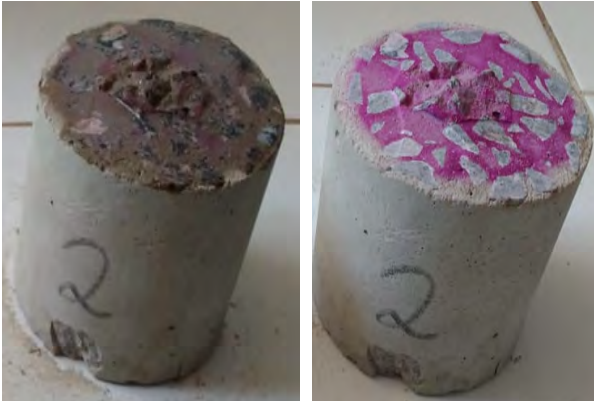
Figura 6 – Corpo de prova 2 com a aplicação da fenolftaleína e após reação
