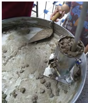
Figura 3 – Concretagem dos corpos de prova
