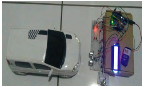
Figura 4. Circuito do sensor após a conexão Bluetooth confirmar a identificação do usuário legalmente destinado à vaga (a luz de LED é apagada).
