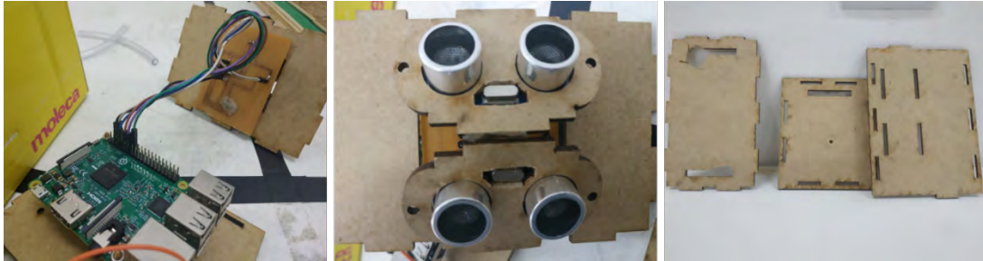
Figura 14 – Raspberry Pi 3 e Placa de Circuito Impresso; Sensores ultrassônicos; partes da base em madeira MDF
