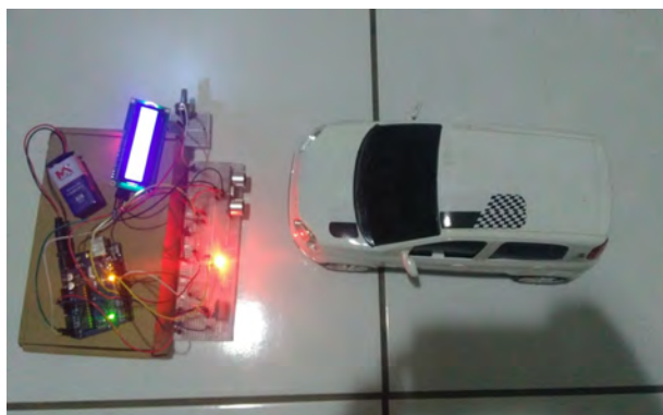
Figura 1. Teste de sensor: aviso de presença de veículo (luz amarela acesa, indicando presença do objeto).
