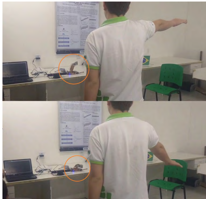
Figura 5 - Teste com Arduino sendo controlado pelo Kinect através do TeamBridge
