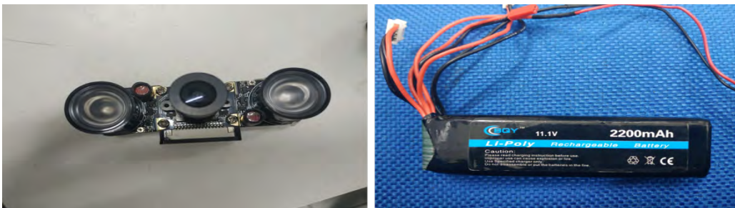
Figura 15 – Pi Câmera com módulo infravermelho; Bateria Li-Po 2200mAh
