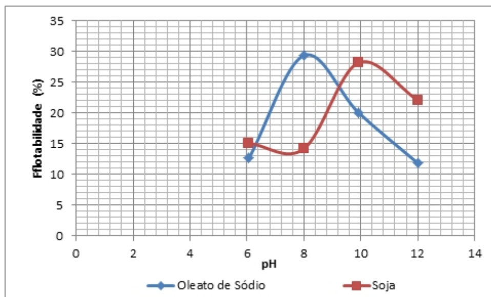
Figura 6 - Flotação da barita usando o oleato de sódio e o óleo de soja de fritura saponificado em função do pH.. Fonte: Autores, 2018.
