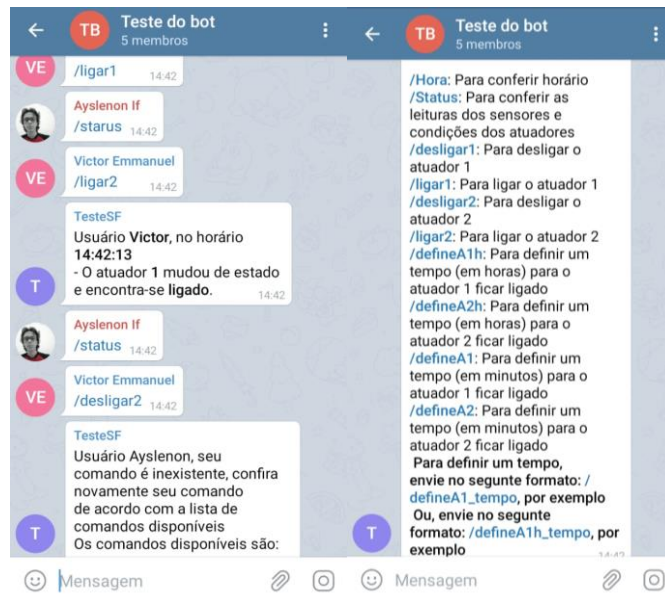
Figura 17: Resposta da Interface ao usuário mandar um comando errado(A) e comandos válidos(B).
