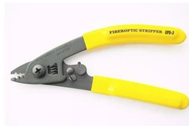
Figura 22 – Alicata Decapador. Utilizado para desencapar a fibra.
