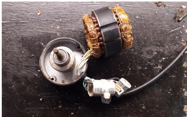
Figura 11: Motor desmontado para troca de capacitor
