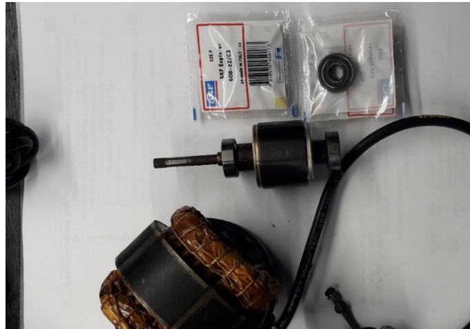
Figura 10: Motor desmontado para troca dos rolamentos
