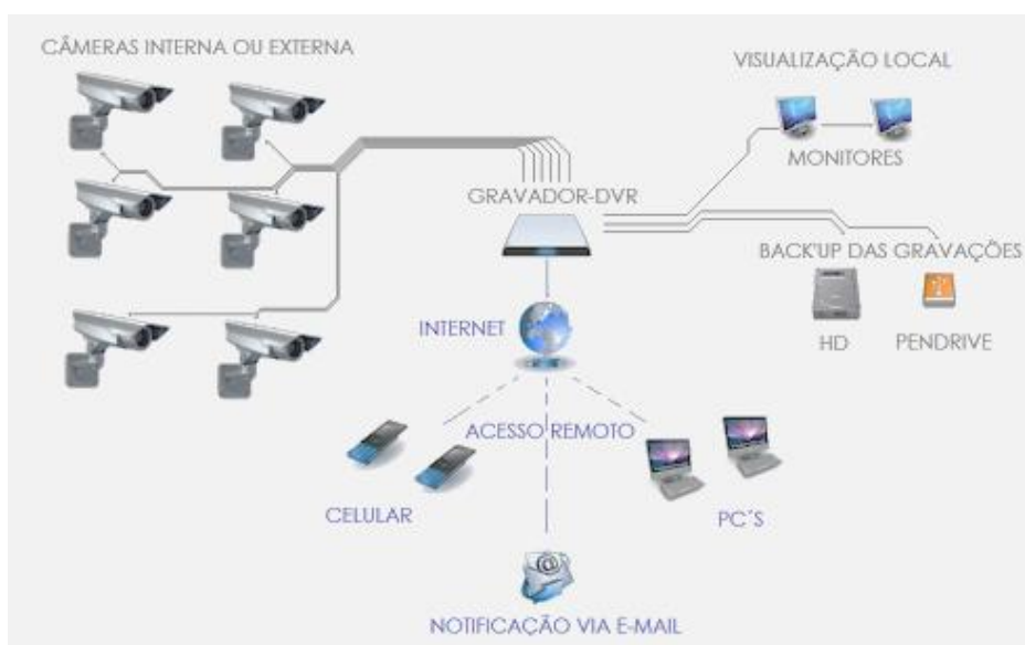
Figura 1 - Esquema de um CFTV
