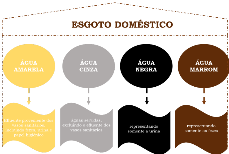
Figura 12 – Segregação do esgoto doméstico.
