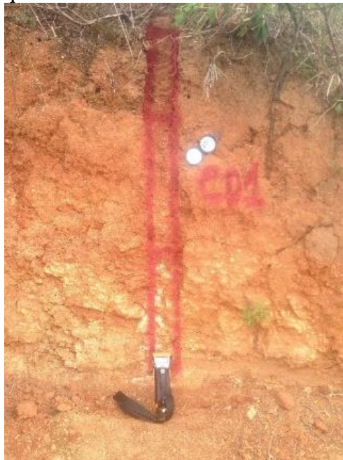
Fotografia 4 – Marcação de uma coleta de amostra de canal realizada em um corte de estrada em zona mosqueada
