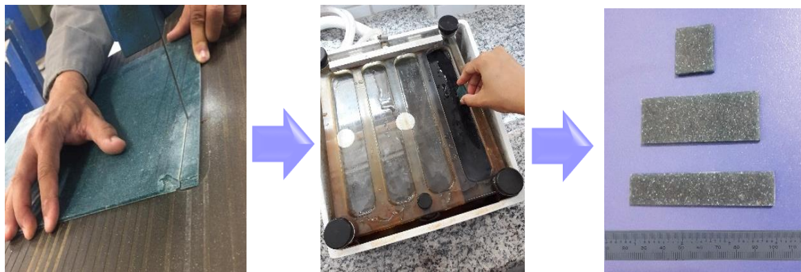
Figura 27 - Processo de confecção dos corpos de prova: (a) corte dos corpos de prova, (b) lixamento dos corpos de prova e (c) corpos de prova para os três ensaios.
