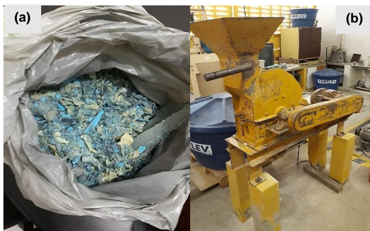
Figura 17 – Resíduo de PRVF e moinho (a) Resíduo de PRVF (b) Moinho de facas
