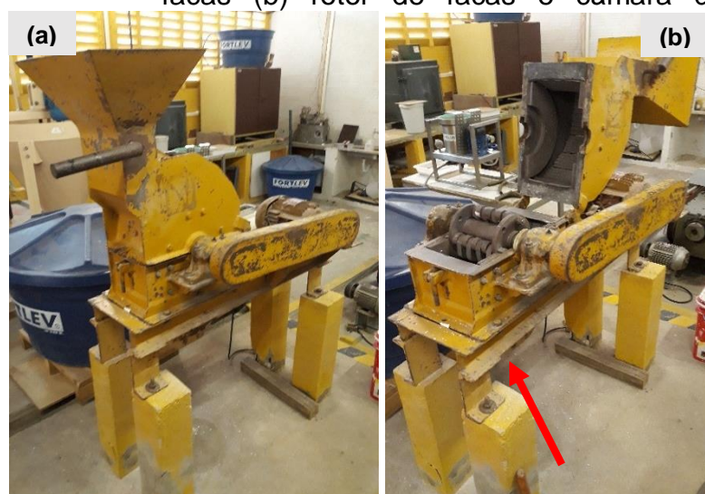
Figura 18 – Moinho de facas (a) bandeja do moinho de facas (b) rotor de facas e câmara de
