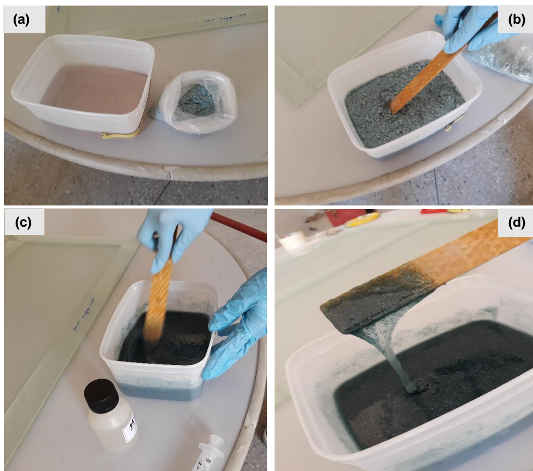
Figura 23 - Massa de resina - Concentração de 20%. (a) Resina e resíduo em PRFV. (b) Junção dos componentes. (b) Adição da solução catalisadora. (c) Textura da MR 20.
