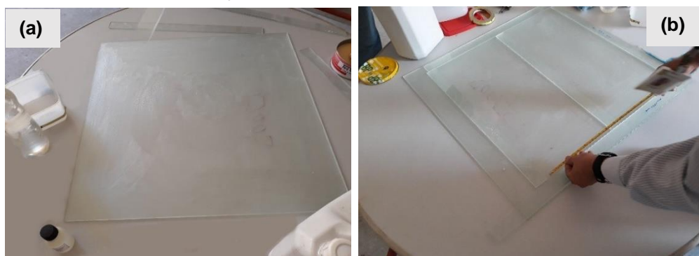
Figura 22 - Preparo do molde. (a) Superfície da placa com desmoldante e (b) medição das dimensões
