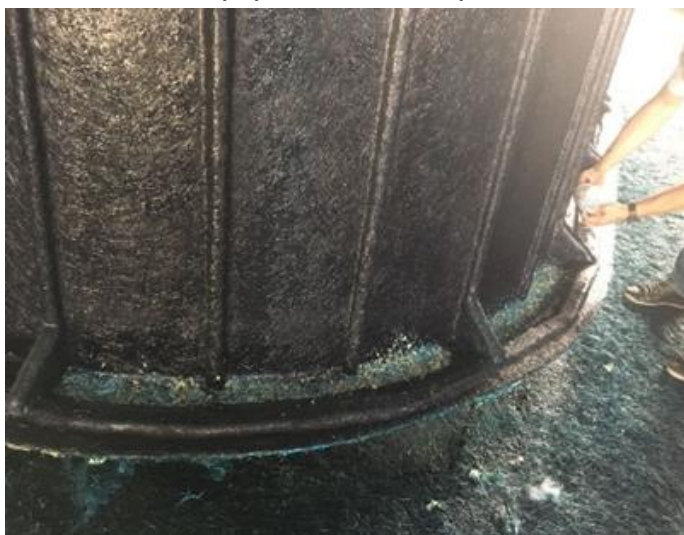
Figura 16 - Resíduo na fabricação de piscinas, presente nas bordas do equipamento e no piso da indústria
