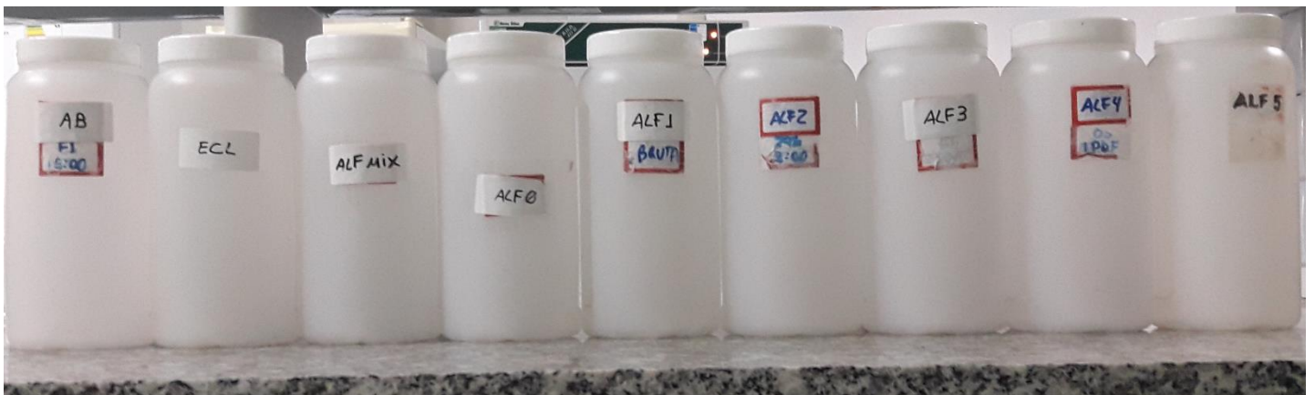
Figura 2 – Recipientes plásticos com amostras de água bruta, água de lavagem dos filtros, efluente clarificado da lagoa de sedimentação e água de lavagem dos filtros minuto a minuto
