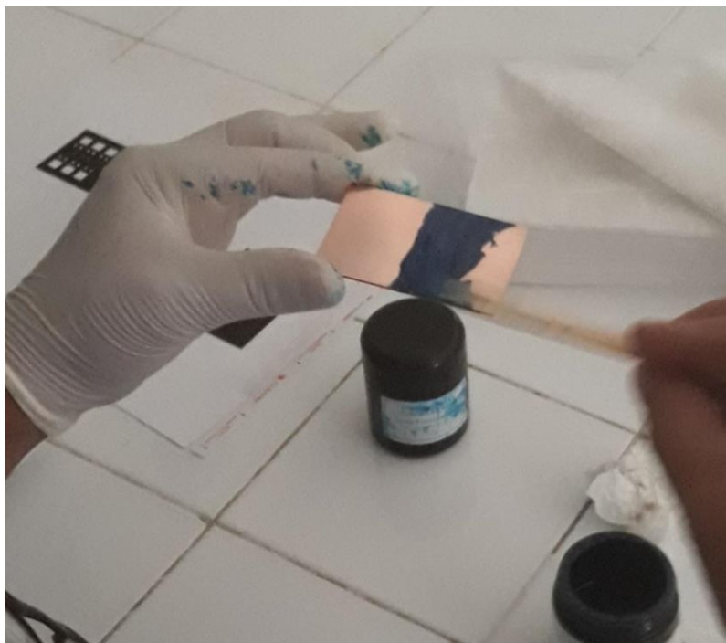
Figura 10: Aplicação da tinta fotossensível.
