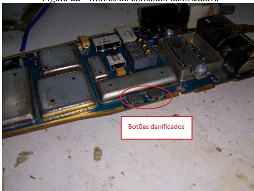
Figura 22 - Botões de comando danificados.
