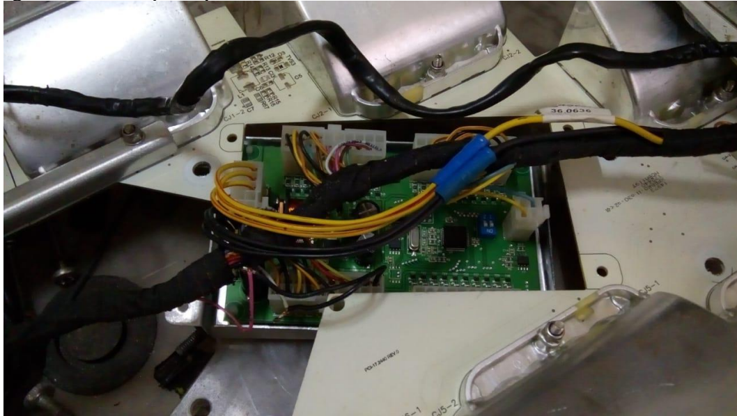
Figura 38 - Placa principal de uma sirene de um carro da Polícia Rodoviária Federal.
