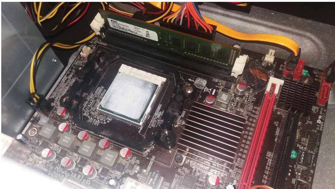
Figura 3 – Processador com pasta térmica recém aplicada
