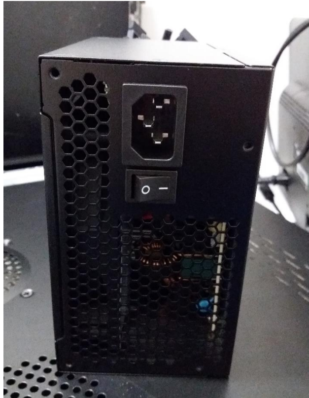
Figura 5 – Fonte de alimentação utilizada nas substituições
