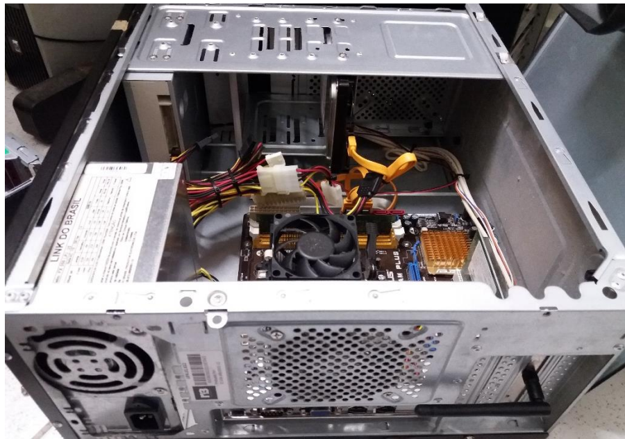
Figura 6 – Gabinete aberto para substituição de fonte queimada
