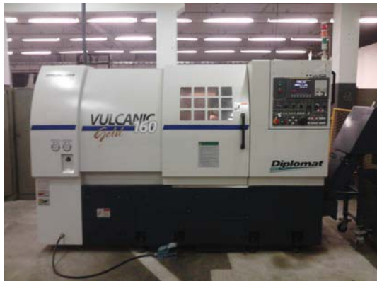
Figura 1 – torno CNC Vulcanic Gold 160
