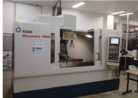
Figura 2 – centro de usinagem Discovery 1000
