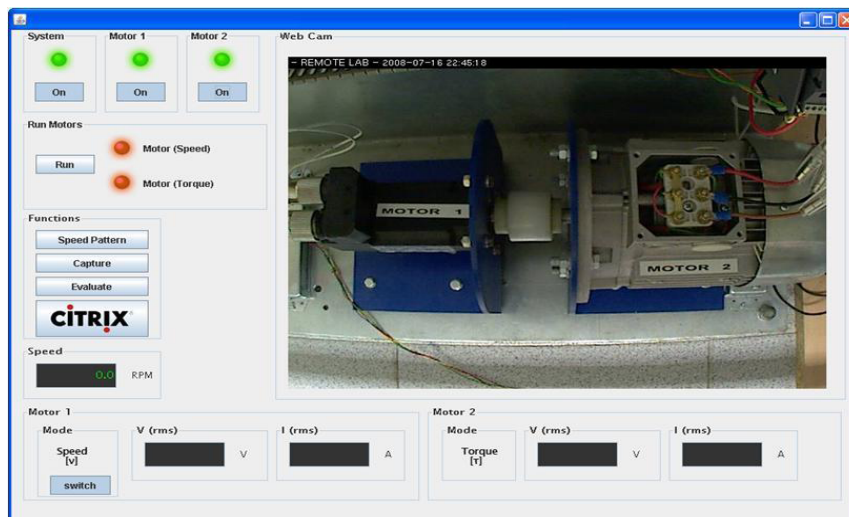
Figura 2 – Exemplo de uma interface de Laboratório Remoto
