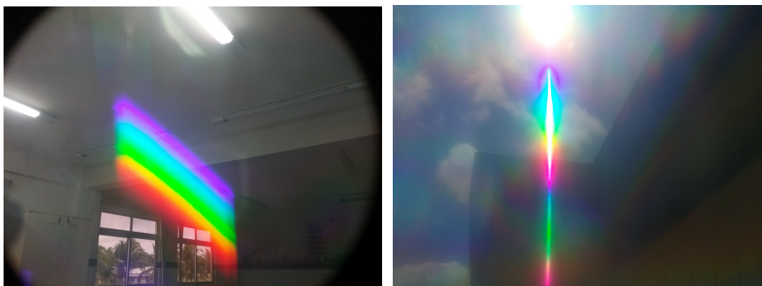
Figura 25 – Imagens do espectro contínuo de lâmpada fluorescente e do sol.
