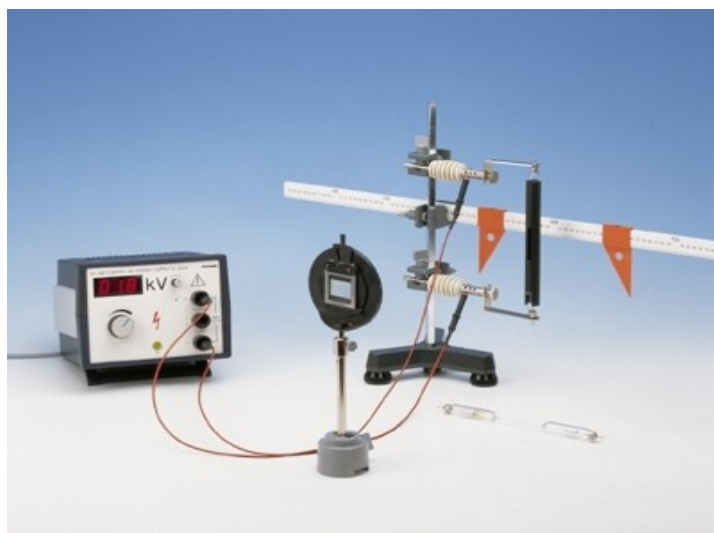
Figura 27 – Experimento PHYWE de espectros atômicos e série de Balmer
