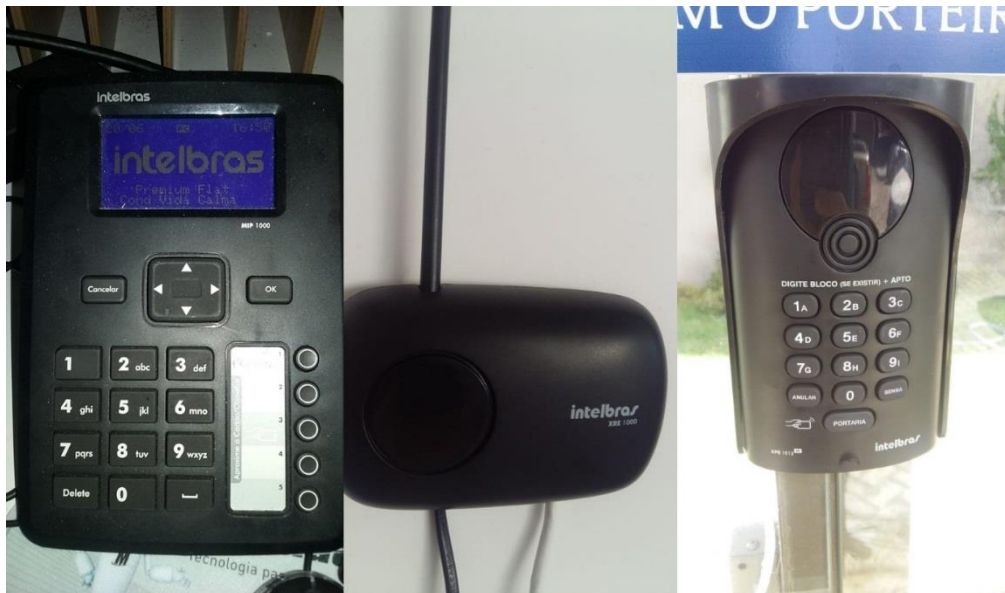
Figura 13: Equipamentos da Linha SCA1000 Intelbras Utilizados
