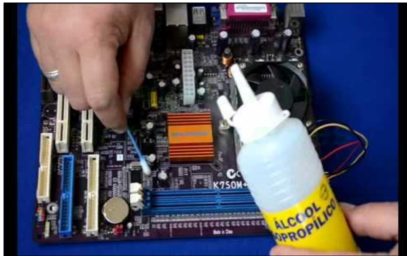
Figura 17: Limpeza da Placa Mãe com Álcool Isopropílico
