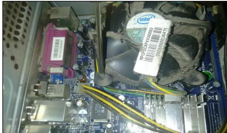
Figura 14: Retirada do cooler
