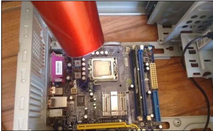
Figura 16: Soprando a placa com um soprador
