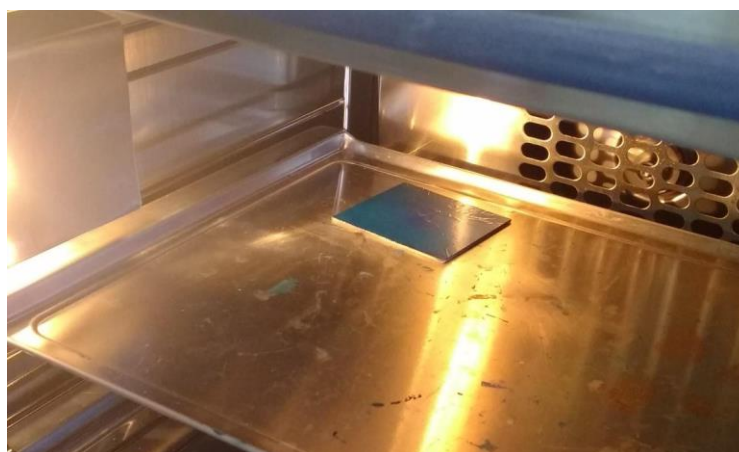
Figura 27 - Processo térmico para remoção dos solventes do polímero fotossensível.
