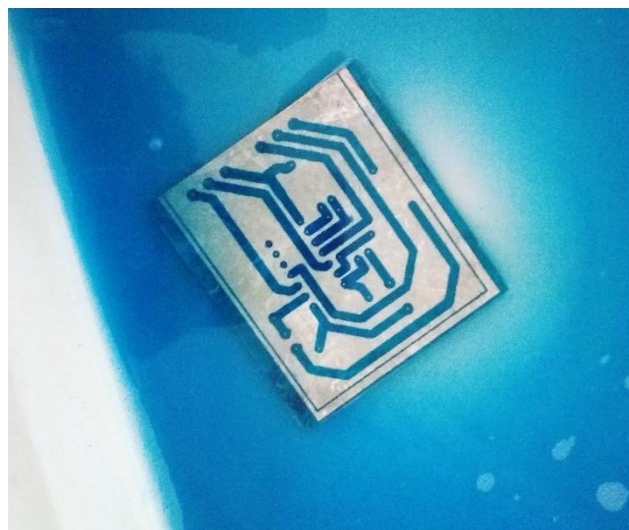
Figura 29 - Revelação do padrão gravado por fotolitografia.
