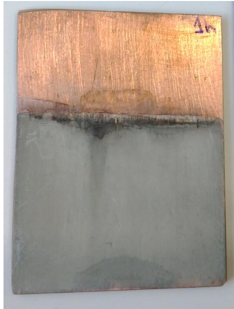
Figura 47 - Depósito de estanho em placa de face única (60 minutos).
