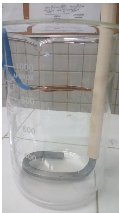
Figura 18 - Arranjo experimental utilizado para a obtenção do Sn(CH_3COO)_2 .
