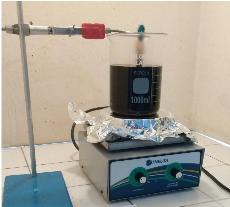
Figura 30 - Processo de corrosão química dos filmes metálicos (estanho e cobre).
