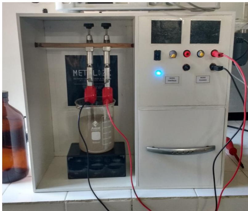
Figura 21 - Setup projetado e fabricado para metalização de substratos em placas de circuito impresso.
