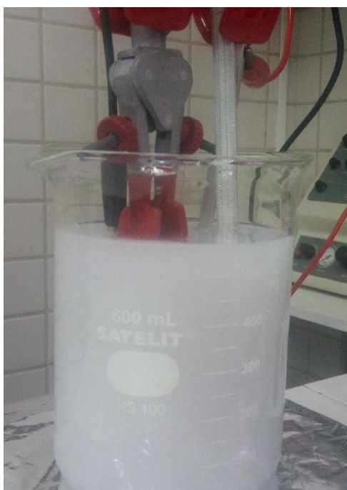
Figura 45 - Formação do acetato de estanho.
