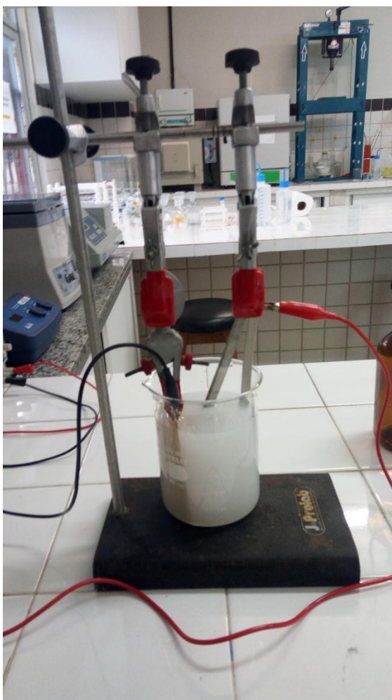
Figura 20 - Arranjo experimental para a eletrodeposição de estanho utilizando fonte DC comercial.
