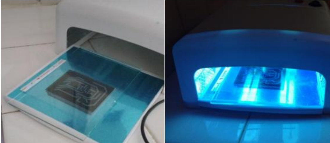
Figura 28 - Preparação do conjunto fotolito-substrato para exposição à radiação UV - fotolitografia.
