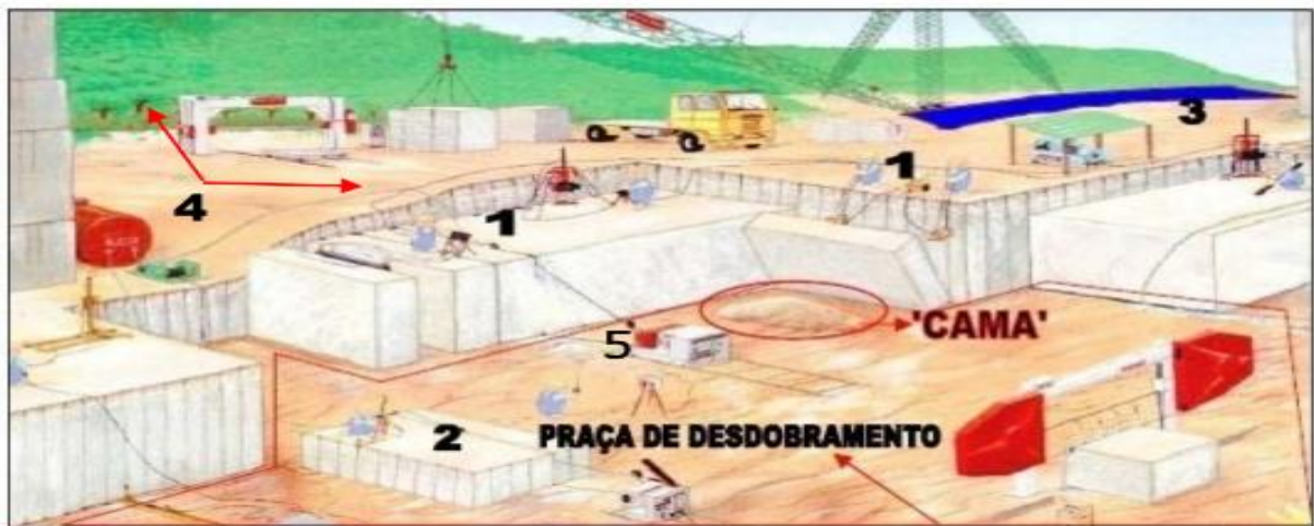
Figura 1 - Ilustração de uma frente de lavra de rocha ornamental, em maciço, utilizando fio diamantado.
