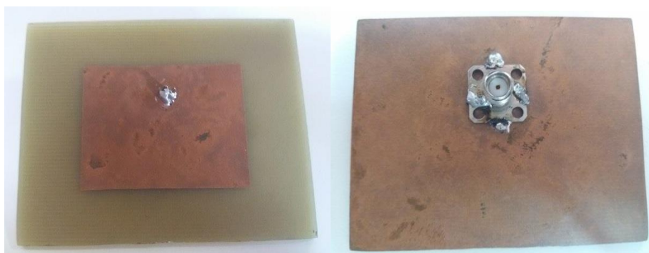
Figura 37 - Antena microfita, utilizando substrato de fibra de vidro, com alimentação por cabo coaxial (a) parte superior e (b) Parte inferior.
