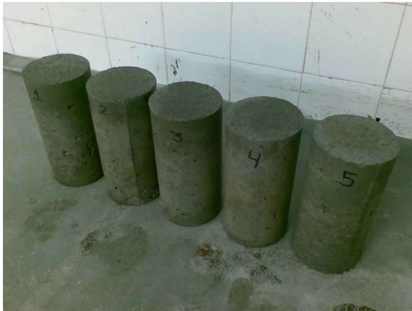
Figura 5: Aspectos visuais dos corpos de prova moldados com os traços T-3, T-4 e T-5.
