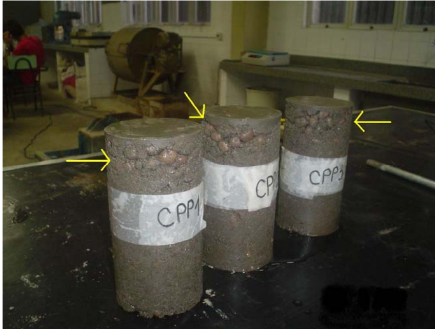
Figura 4 – ninhos de concretagem (traços T-1 e T-2).
