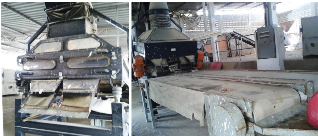
Figura 4. Equipamento de separação pneumático usado pela Mineração Florentino para o beneficiamento de mica.
