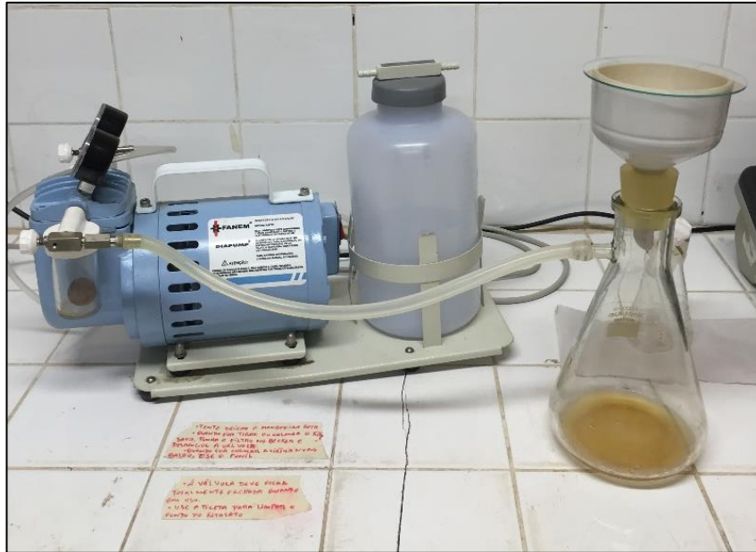
Fotografia 11 – Detalhe para os materiais utilizados durante a etapa de filtração.
