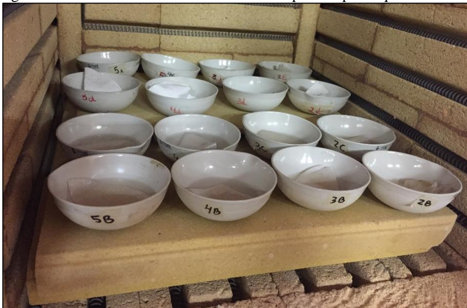
Fotografia 12 – Amostras armazenada na Mufla para etapa de queima à 700°C.
