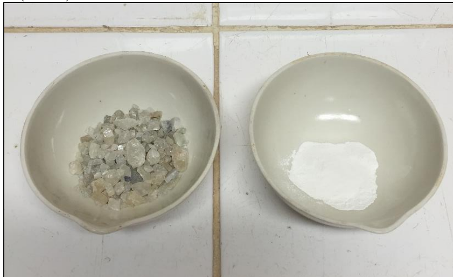
Fotografia 7 – Amostras da Scheelita pura antes (esquerda) e após o processo de cominuição (direita).
