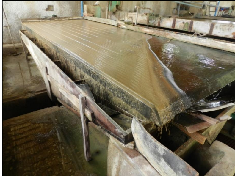
Fotografia 5 – Visão frontal para mesa concentradora vibratória em operação.
