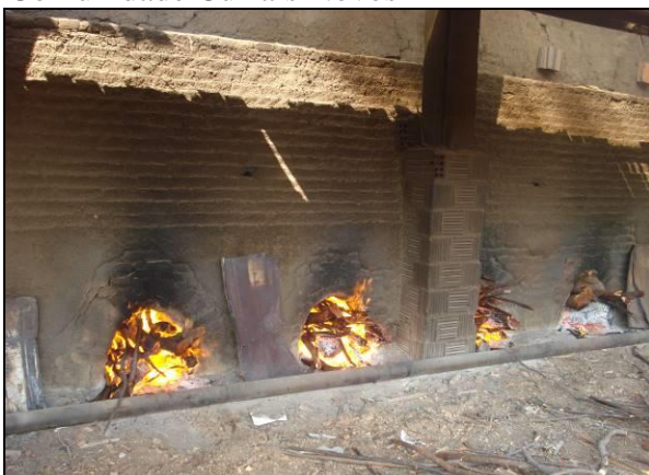
Figura 44 – Queima de lenha nos fornos de uma indústria de cerâmica vermelha na Comunidade Currais Novos
