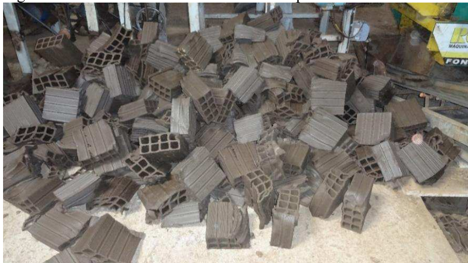
Figura 2 – Blocos crus úmidos defeituosos após o corte.
