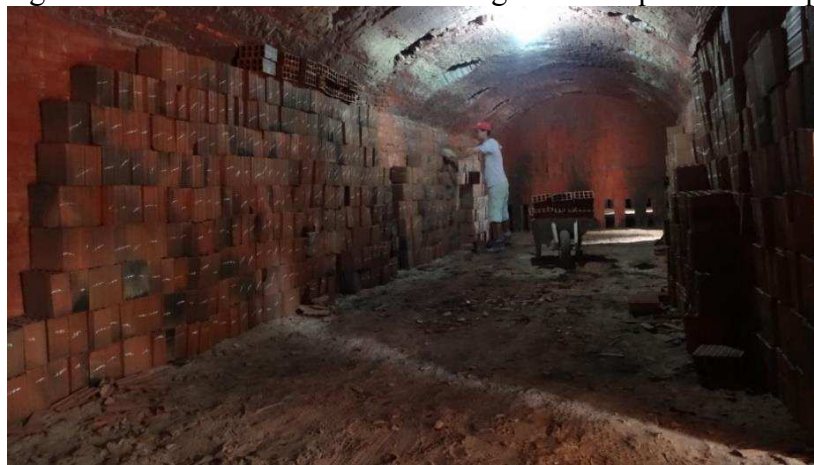
Figura 5 –Blocos cozidos defeituosos gerados no processo de queima.
