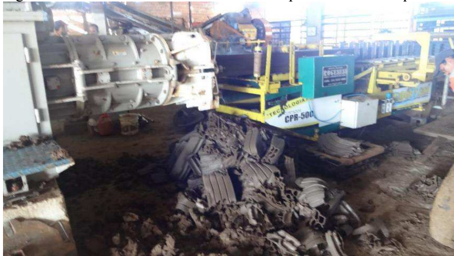
Figura 1 – Blocos crus úmidos defeituosos após a saída da boquilha da extrusora.
