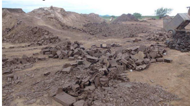
Figura 4 – Reutilização de blocos crus secos defeituosos na estocagem de argila.
