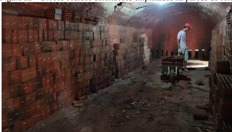
Figura 22 – Blocos cozidos defeituosos empilhados na parede do forno.
