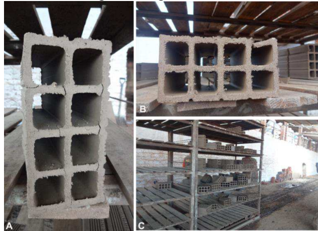
Figura 3 – Bloco cru seco trincado (A), bloco cru seco deformado (B) e blocos crus secos com essas não conformidades (C) sendo transportados para serem reutilizados na estocagem de argila.
