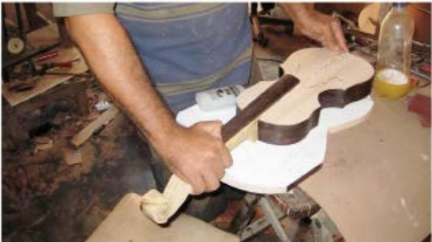
FIGURA 40 – Rabeca após a retirada dos sargentinhos no processo de colagem
