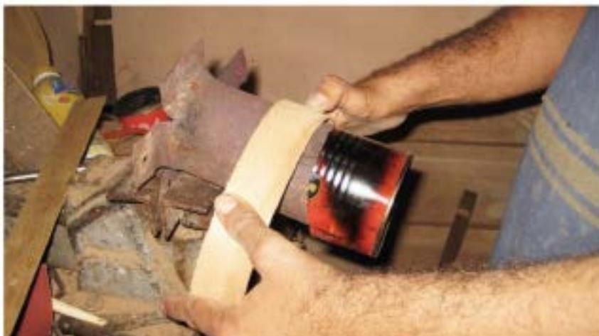
FIGURA 35 – Processo de retorcer as faixas laterais no cilindro aquecido
