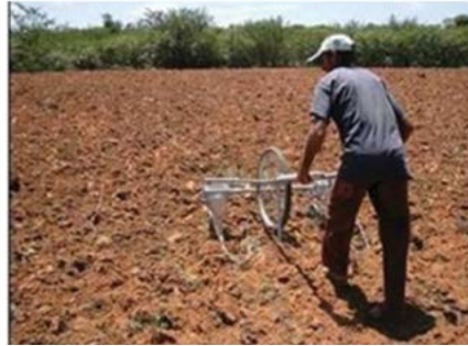
Figura 4: Semeadora mecânica manual de duas linhas para semeadura de sementes de gergelim. Detalhe da semeadura (A); e prática de semeadura (B), 2010.
