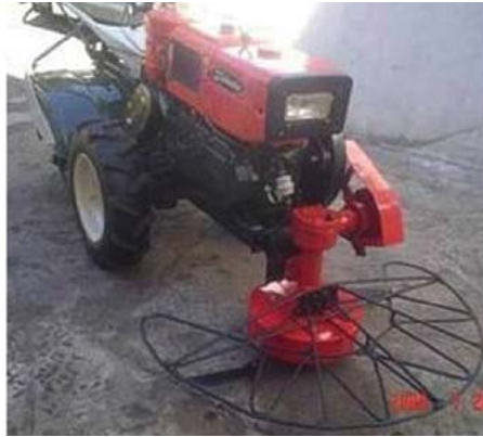
Figura 8: Mini-tractor com roçadeira frontal (pesquisa ainda não validada) para o corte mecânico de uma linha de plantas de gergelim.
