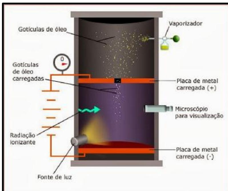
Figura 04 – Experimento de Millikan para determinação da carga do elétron - 1916
