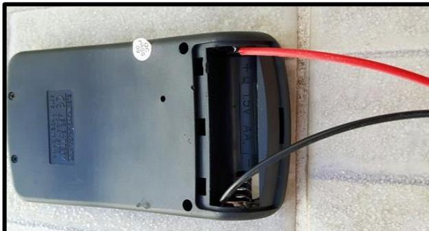
Figura 19 – Soldas dos fios na calculadora.
