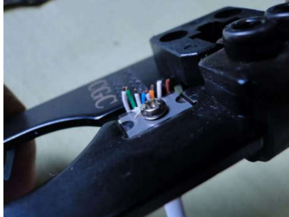
Figura 8. Corte alinhado dos fios desenrolados.
