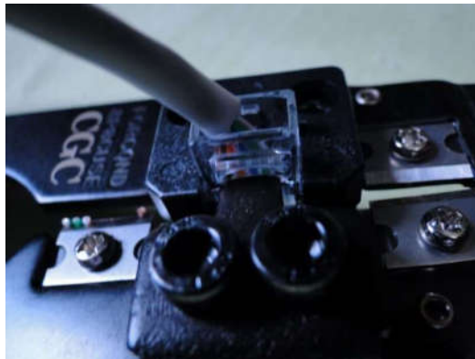
Figura 11. Aperto feito com o alicate crimpador entre as abas de emenda de cobre ao conector.
