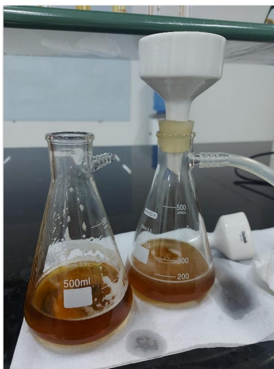
Figura 17 – Óleo residual, submetido a filtragem inicial, antes de ser submetido a reação de transesterificação. (Fonte: Autor, 2022)
