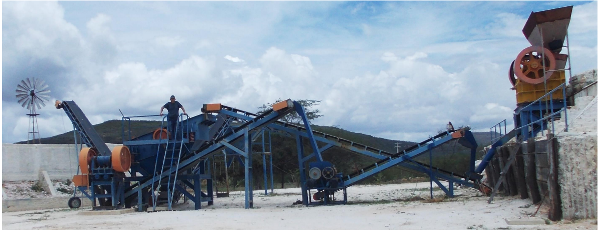
Figura 3 – Planta de fragmentação para obtenção de quartzo em frações.
